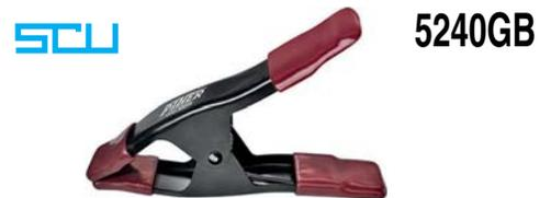
Corpo in nylon rinforzato con fibra di vetro. Pressione di serraggio regolabile tramite vite che agisce sulla molla di chiusura. Molla temprata extra resistente. Ganasce mobili.
